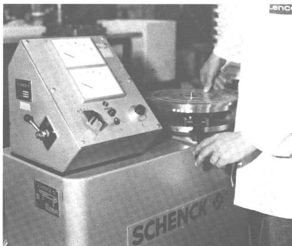
Macchina elettronica per la perfetta equilibratura dei piatti. L'alta equilibratura della planarità del piatto completa le operazioni di controllo.
