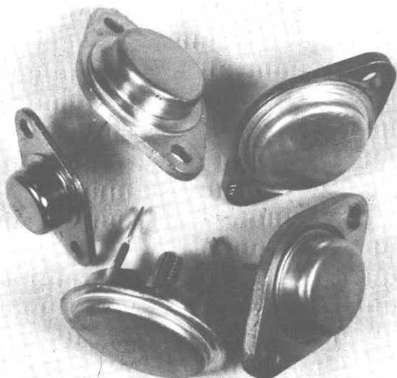
I regolatori di tensione che provvedono a dimensionare la tensione di alimentazione secondo le esigenze circuitali si avvalgono del proprio dissipatore mentre TR3, il transistor di potenza che assicura la corrente necessaria, è fissato su di un'aletta di raffreddamento.
